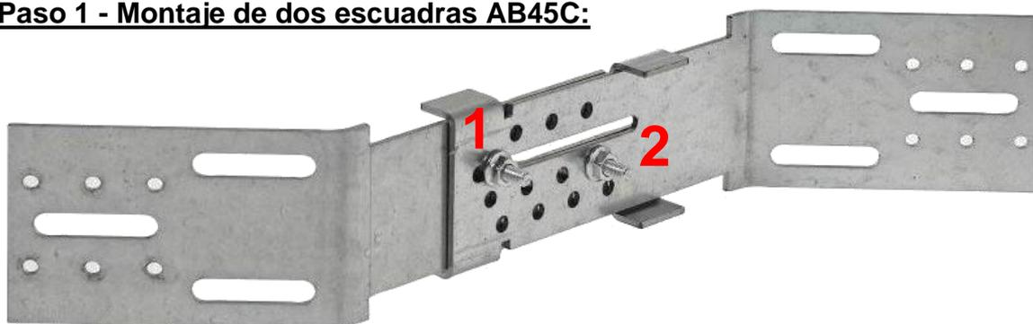
**1** La primera fijación en el (agujero oblongo) mantiene ambas escuadras unidas. También permite ajustar la unión en función del grosor del aislante y de la sección del cabrio.
