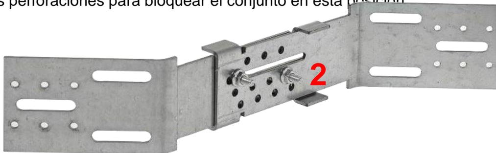
Las perforaciones de bloqueo permiten realizar **17 posiciones de ajuste**, lo que permite ajustar la escuadra de **4 mm en 4 mm** según el grosor del aislante.
